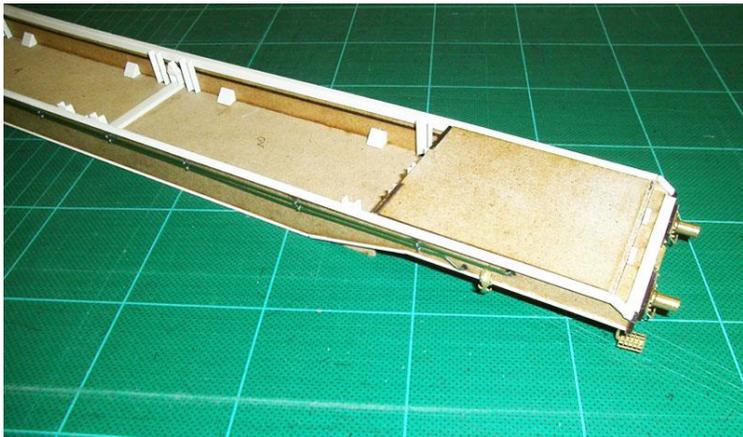
Weiter werden die Messing-Teile wie Kupplungsmund, Rangiergriffe, Pufferhülse, Tritte, Bremsschalter eingeklebt.
