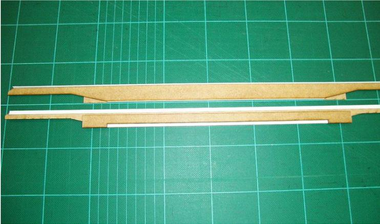
Die Bodenplatte wird mit den beiden Stirnseiten zwischen die beiden Seitenwände geklebt, gleich wie das Drehgestell Plattformen.
