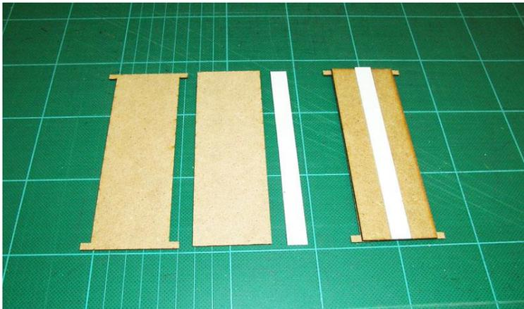
Die beiden Tragwerk Rahmen werden gegen die Führungstreife geklebt, und bestückt mit Holzleisten.
