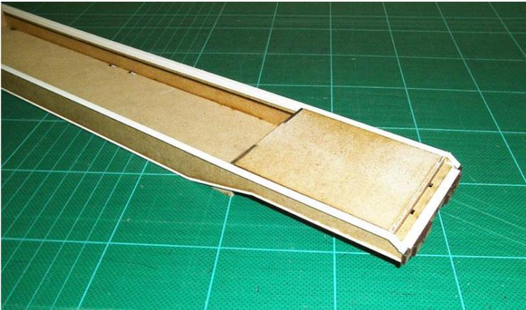
Die gedoppelte Drehgestell-Brücke wird eingeklebt.
