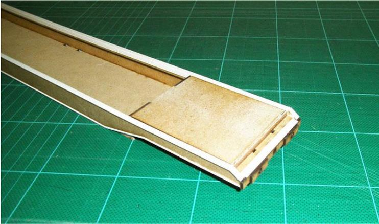
Auch der Profil-Längsträger wird weitergezogen bis an die Pufferbohle.
