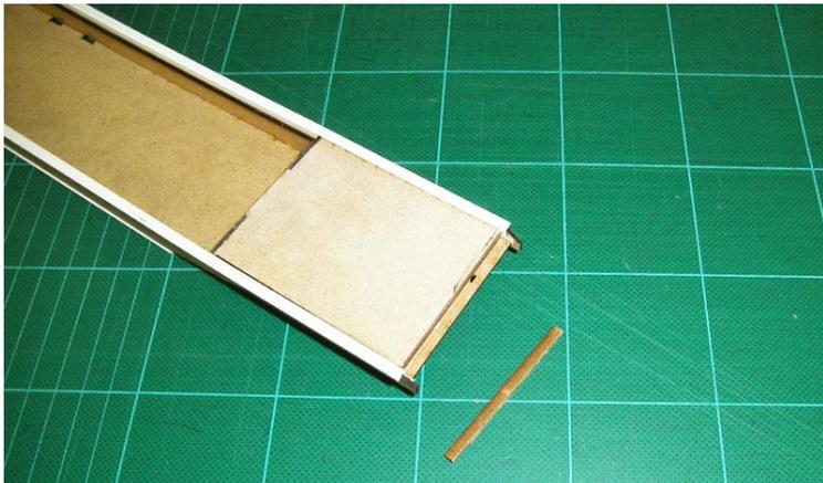
Die Drehgestell-Brücke und die Pufferbohle werden gedoppelt.
